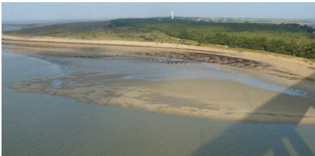
21-11-2010 : Banc de sable nouvellement créé à droite du pont. Un contre courant s'est formé autour de ce banc, le contre courant retourne ouest-est le long de la côte jusqu'au banc de sable au delà du pont vers l'est (image suivante), puis retourne ouest, repris par le courant de jusant est-ouest.
